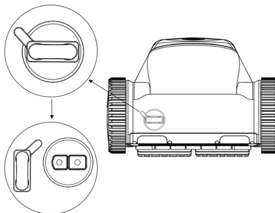
③ Mit dem beiliegenden Ladegerät an die Stromversorgung (100-240 V) anschließen. Der Batteriestand wird auf der Batterieleiste angezeigt. Wenn alle 3 Balkenleuchten leuchten, ist der Roboter vollständig geladen. Laden Sie den Roboter vor dem ersten Gebrauch vollständig auf.
