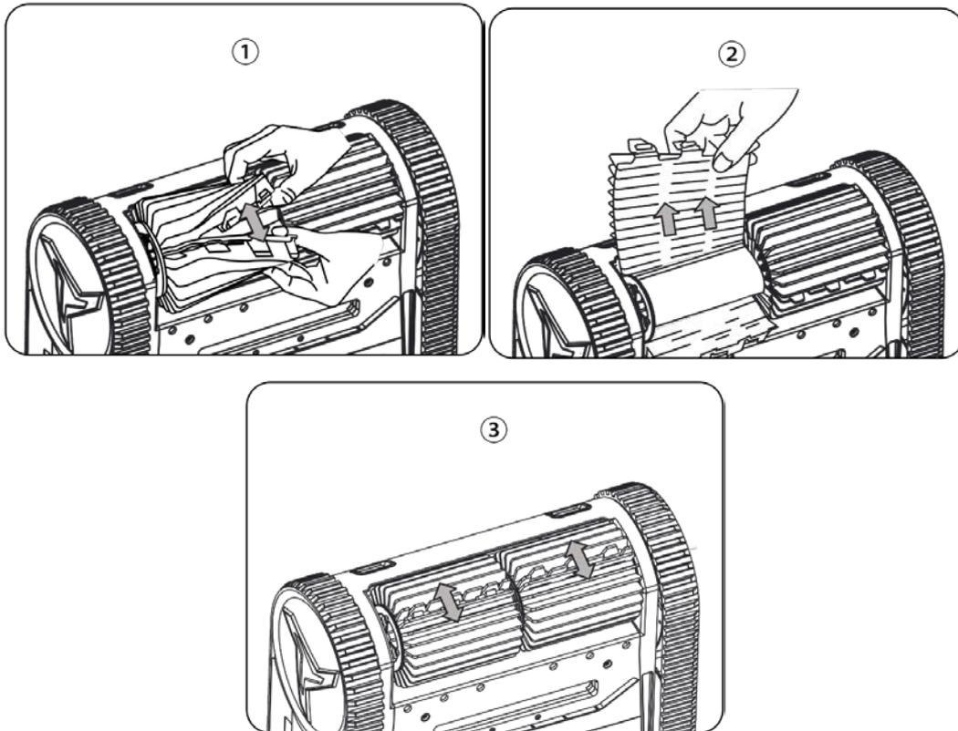
1. Lösen Sie die Laschen aus den Löchern und entfernen Sie die Bürsten: ①→②→③
